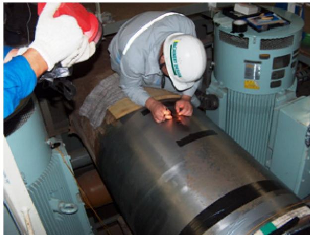
Fixarea pe arbore a marcilor tensometrice pentru masurarea si analiza cuplului la ax la propulsoarele navelor maritime
