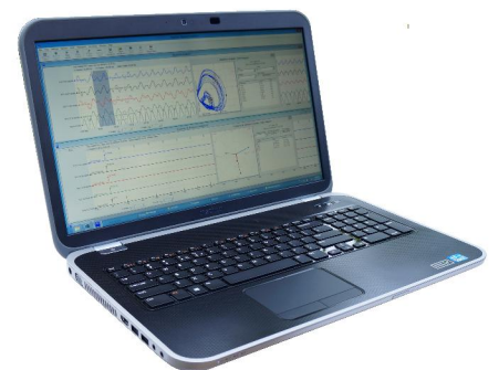
Diagnoza sau echilibrarea pot fi efectuate prin simpla conectare a sistemului de calcul la portul Ethernet
