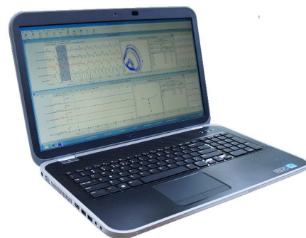
Diagnoza sau echilibrarea pot fi efectuate prin simpla conectare a sistemului de calcul la portul Ethernet
